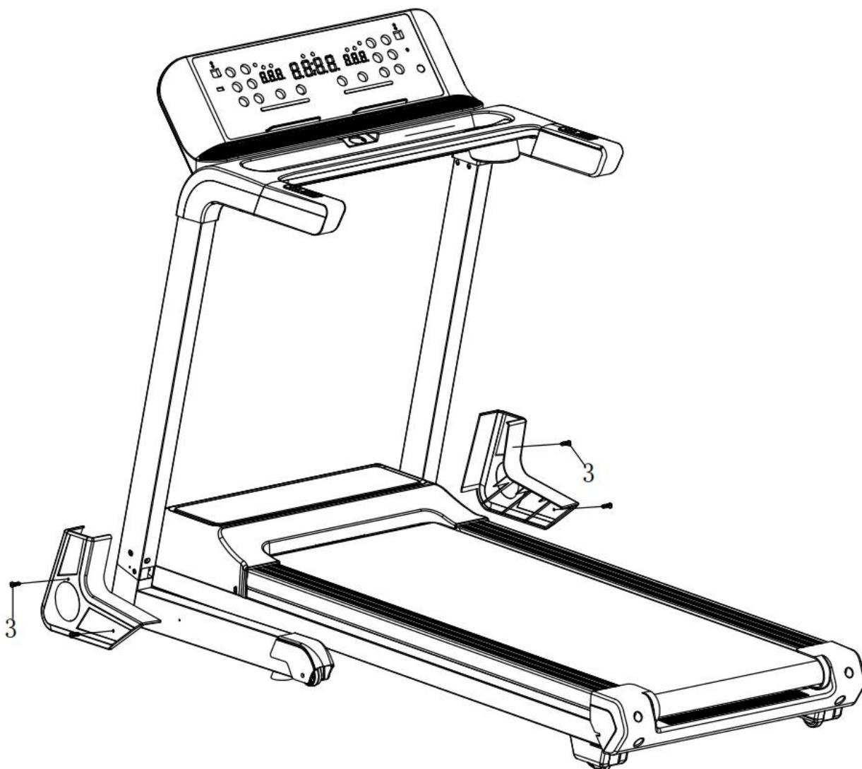
**ÉTAPE 4** Utilisez les vis M4,2\*16 fournies (3) pour verrouiller fermement le couvercle du montant vertical sur le montant (16L/R).
